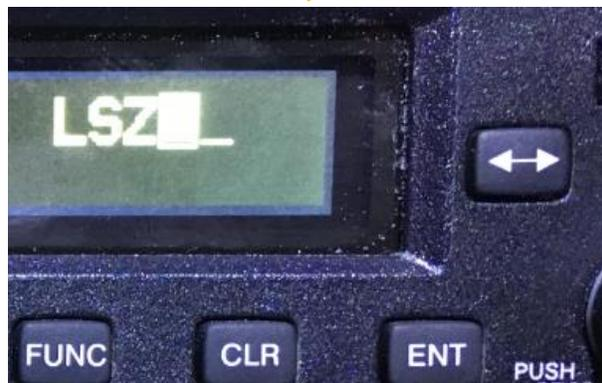
Drücken um in den Frequenzspeicher zu gelangen. Der innere Drehknopf wählt den Buchstaben, der äussere die Position.
